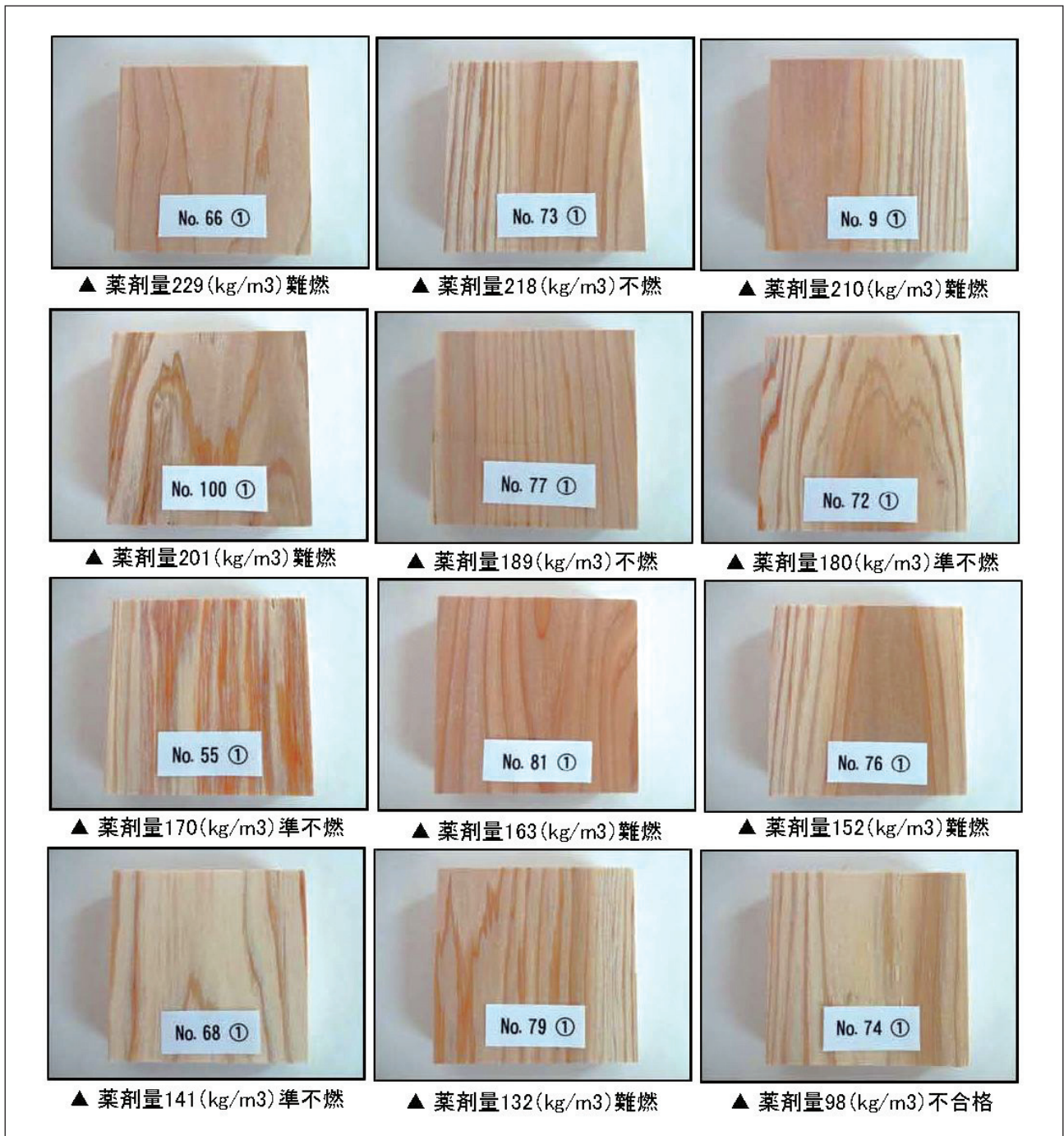
図-12 試験体のコーンカロリーメータによる燃焼試験
